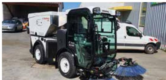
Le Commune a changé sa balayeuse de voirie il y a quelques mois : il s'agit d'une balayeuse MULTIHOOG CV350 1 avec kit haute pression, kit 3 caméras et aspiration localisée, en location longue durée.
