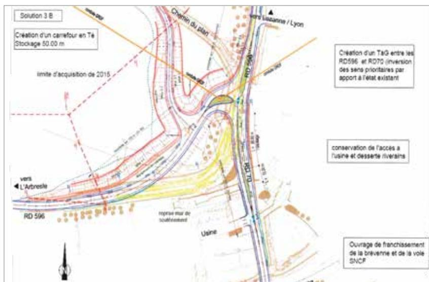
Le Département a donc programmé la réalisation d'un carrefour en T, à l'intersection de ces RD596 et 70, pour faciliter l'écoulement du trafic.
